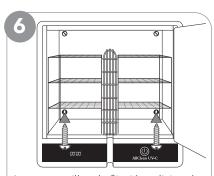
Inserte tornillos de fijación adicionales en los orificios de montaje en la parte inferior de la unidad AllClean.
