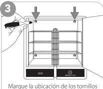
en los orificios de montaje superiores en la parte posterior de la unidad.
